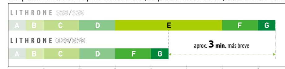
A-Ajuste del aspirador B-Detección de doble hoja C-Ajuste de la rueda de cepillos D-Ajuste de las pinzas del cilindro A E-Ajuste de los tacos de pinzas del cilindro de transferencia F-Ajuste de la guía del papel en el cilindro impresor G-Ajuste de la presión de impresión B-I
